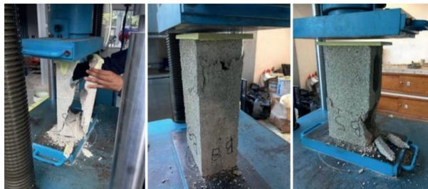
El esfuerzo de compresión  $\sigma_x$ , resulta de dividir la carga de ruptura entre el área neta, a continuación, mediante la Ec. (2) (Gere y Goodno, 2009) se obtiene  $\tau_{m\acute{a}x}$ , el esfuerzo máximo de cortante en la pieza.
